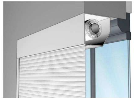
Recess fit B: Inward roller
