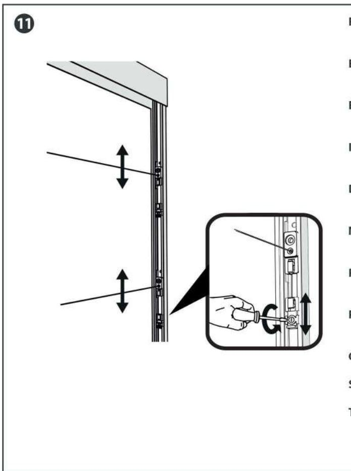
**FR** | Pour ajuster la tension du mécanisme de retour de toile, enlever les pièces G (étape 7), puis modifier la hauteur des pièces blanches (plus elles sont éloignées de la pièce fixe, plus la moustiquaire aura de tension pour revenir à sa place d'origine).
