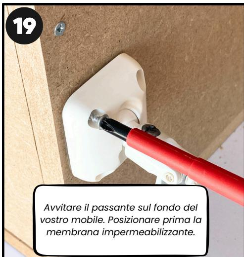
Avvitare il passante sul fondo del vostro mobile. Posizionare prima la membrana impermeabilizzante.
