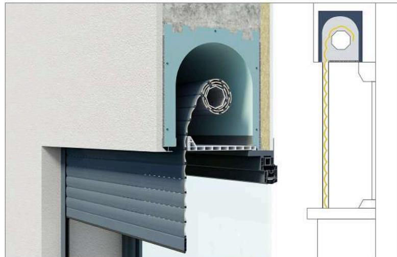
**FR | Pose tunnel - enroulement vers l'intérieur****EN | Recessed installation - internal roll-up****DE | Einbaurolladen mit Kasten - Innenlauf****ES | Instalación en hueco - enrollamiento interior****IT | Installazione in mazzetta - avvolgimento interno****NL | Tunnelplaatsing - binnenoprol**
