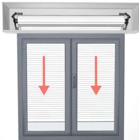
**F** Laisser le point de commande en position "Descendre". Ajuster la position de la butée basse en tournant la vis de réglage vers le +
