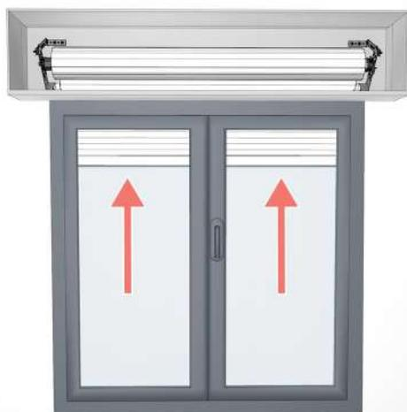
**D** Laisser le point de commande en position "Monter". Afin de repérer la butée haute, tourner une des vis de réglage vers le +. Si le volet remonte, cette vis de réglage est bien celle de la butée haute. Si le volet ne bouge pas, cette vis de réglage est celle de la butée basse. Ajuster la position de la butée haute, repérée précédemment, en tournant la vis de réglage vers le +
