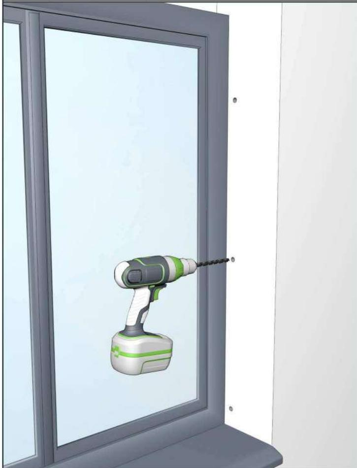
**10** Passer la manoeuvre du volet roulant dans le dormant (ou le mur pour le cas d'une pose applique) et repositionner l'ensemble du volet roulant.
