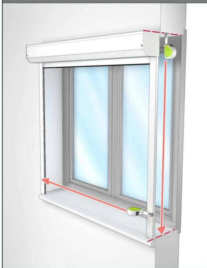
**4** Mesurer les dimensions **X** et **Y** pour la sortie de manoeuvre sur le coffre du volet roulant, et les reporter sur le dormant de la fenêtre.
