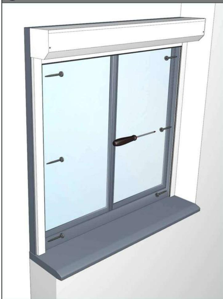
Appliquer un joint silicone sur le pourtour du volet roulant afin de garantir une isolation parfaite.
