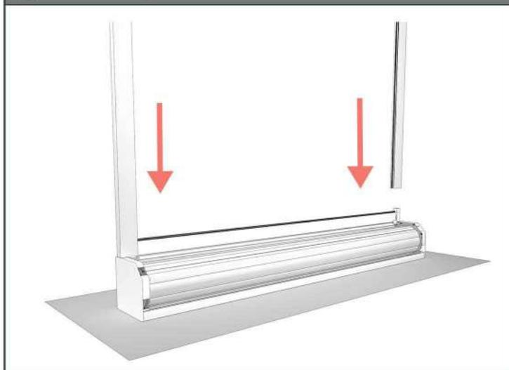
2 Positionner le volet roulant contre une surface verticale plane.
