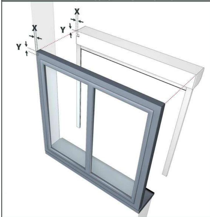
**5** Percer le montant de la fenêtre, de l'intérieur dans un souci d'esthétique, selon le tableau de perçage ci dessous.
