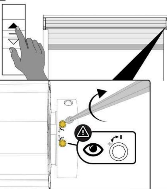
**FR** | Appuyer sur le bouton **MONTÉE** du point de commande, le volet roulant s'arrêtera à une certaine hauteur. Si le volet roulant ressort des glissières, le réengager, le faire redescendre un peu, appuyer sur le bouton **STOP**.
