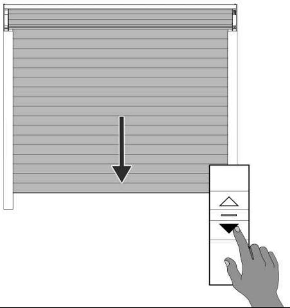
**FR** | Appuyer sur le bouton **DESCENTE** du point de commande; le volet roulant s'arrêtera à une certaine hauteur. Si le volet veut descendre sous les glissières, ne pas "forcer" le moteur. Appuyer sur le bouton **STOP** et refaire quelques tours vers le **-** de la vis de réglage de la butée basse uniquement.
