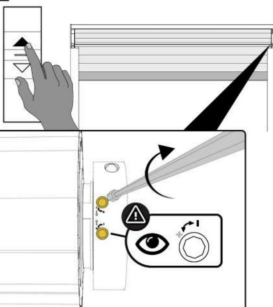
**FR** | Appuyer sur le bouton **MONTÉE** du point de commande, le volet roulant s'arrêtera à une certaine hauteur. Si le volet roulant ressort des glissières, le réengager, le faire redescendre un peu, appuyer sur le bouton **STOP**. Faire 5 tours ou plus vers le — sur les 2 vis de réglage de la tête moteur. Répéter l'opération si nécessaire.
