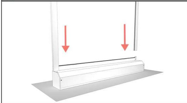
**3** Plaats het rolluik tegen een muur om de boven- en onderaanslag van het rolluik te controleren.
