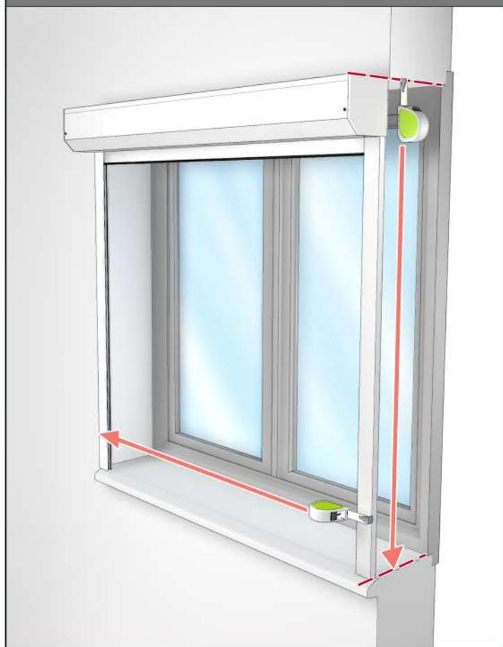
**4** Meet de afmetingen **X** en **Y** voor de bedieningsuitgang op de rolluikkast en breng ze over op het kozijn.
