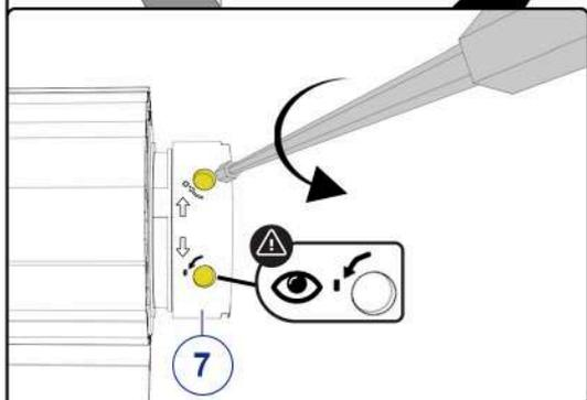
**FR** | Appuyer sur le bouton **MONTÉE** du point de commande, le volet roulant s'arrêtera à une certaine hauteur. Si le volet roulant ressort des glissières, le réengager, le faire redescendre un peu, appuyer sur le bouton **STOP**. Faire 5 tours ou plus vers le — sur les 2 vis de réglage de la tête motrice. Répéter l'opération si nécessaire.
