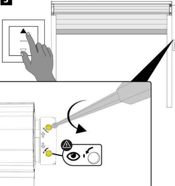
**FR** | Appuyer sur le bouton **MONTÉE** du point de commande, le volet roulant s'arrêtera à une certaine hauteur.
