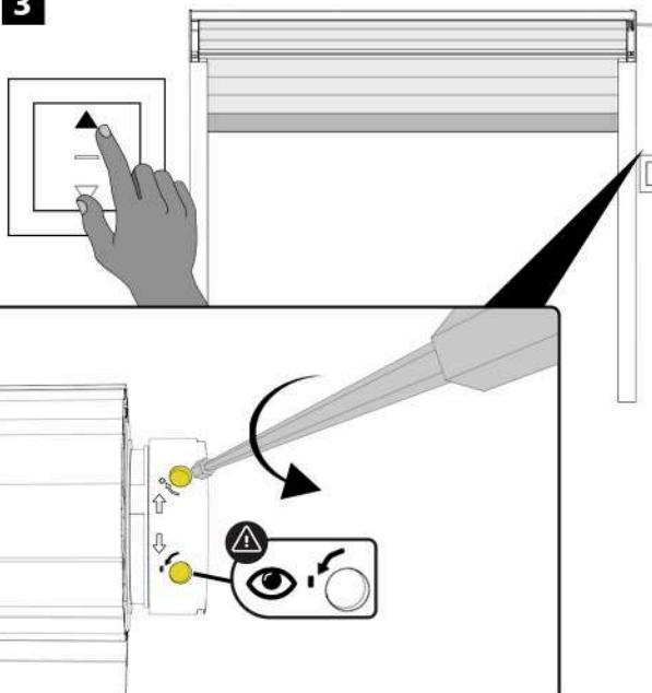
**FR** | Appuyer sur le bouton **MONTÉE** du point de commande, le volet roulant s'arrêtera à une certaine hauteur. Si le volet roulant ressort des glissières, le réengager, le faire redescendre un peu, appuyer sur le bouton **STOP**.
