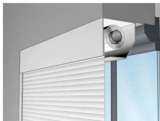
Entre tableau enroulement intérieur
