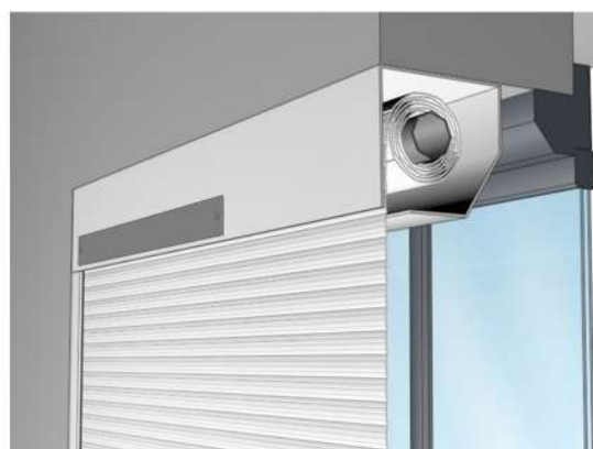
Entre tableau enroulement intérieur
