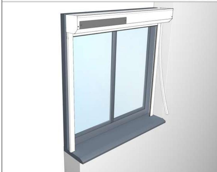
Solo per l'installazione sulla facciata, posizionare i tappi in dotazione sulle guide per nascondere i fori di perforazione.
