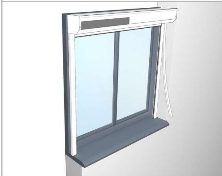
Pour une pose en applique uniquement, placer les capuchons fournis sur les glissière afin de masquer les trous de perçage.
