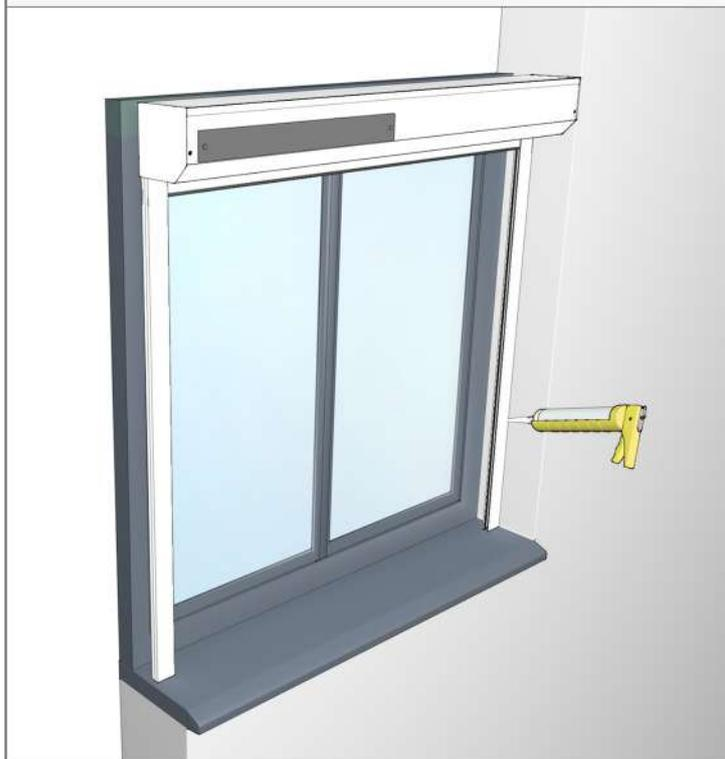
Si l'écart entre le mur et le volet roulant est trop important, appliquer un fond de joint en mousse.
