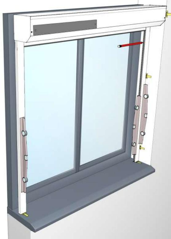
**9** Retirer le volet roulant afin de pouvoir percer et cheviller aux repères réalisés à l'étape précédente.
