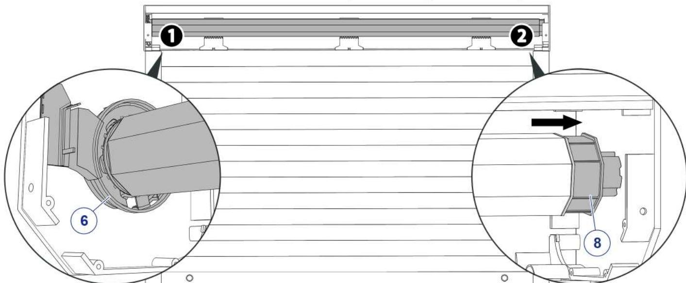
**16** Fixer l'embout de tube sur l'axe.
