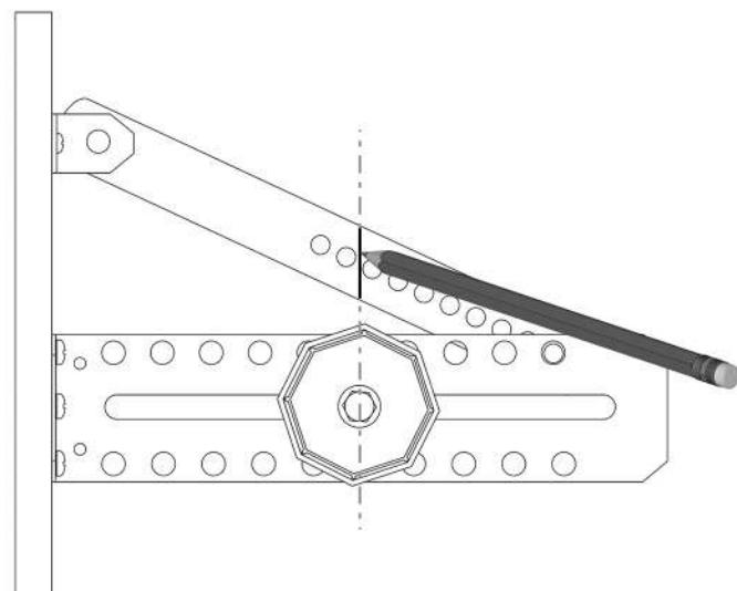
Wenn Sie sich für den Gurtzug entschieden haben, schrauben Sie den Gurtwickler von der Wand und entfernen Sie den Gurt (drehen Sie die Welle um sich selbst um an den Befestigungspunkt zu gelangen).
