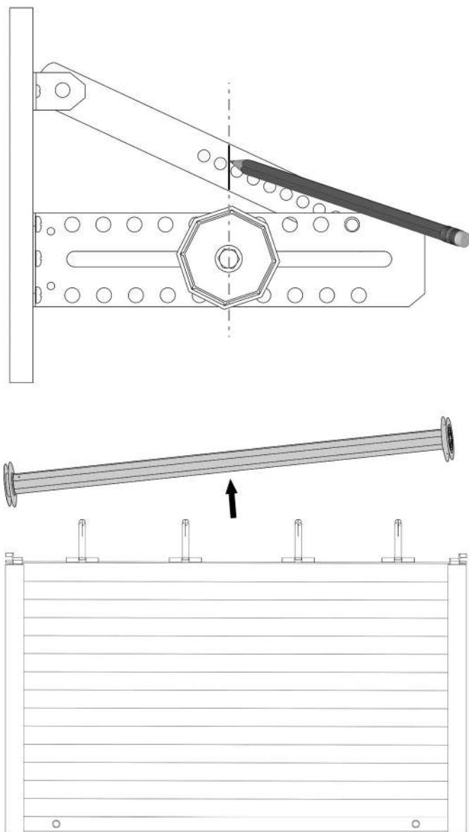
In caso di manovra con cinghia, smontare l'avvolgitore e rimuovere la cinghia dalla flangia (ruotare l'asse per individuare il punto di fissaggio).
