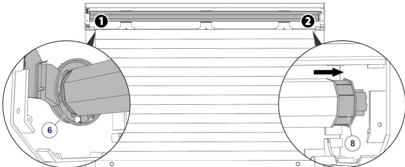
**16** Walzenkapsel an der Welle befestigen.
