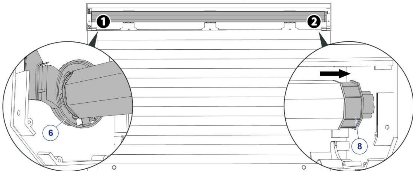
**16** Fissare l'estremità del tubo sull'asse.
