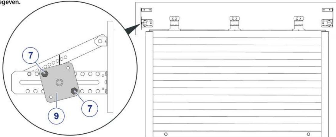
Til de eerste lamel van het rolluik en de bevestigingen op en plaats dan de as. -Bevestig eerst de motorzijde.
