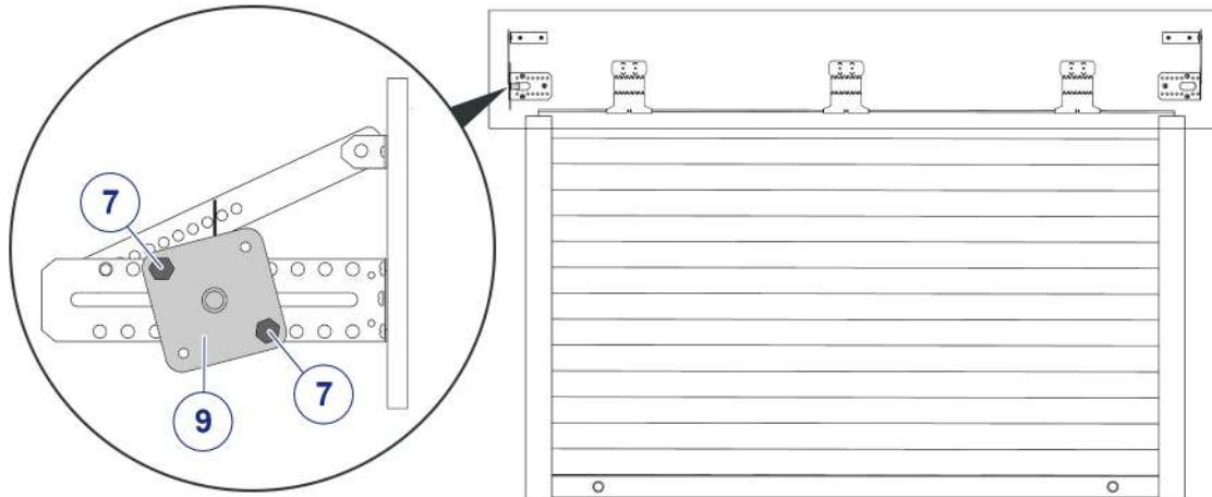
Relever la première lame du volet roulant ainsi que ses fixations, puis positionner l'axe.
