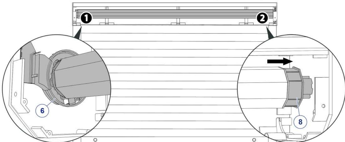
**16** Fixer l'embout de tube sur l'axe.
