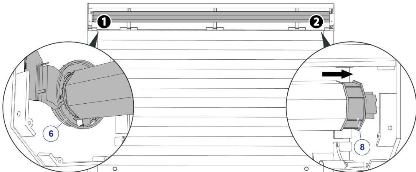
**16** Fissare l'estremità del tubo sull'asse.
