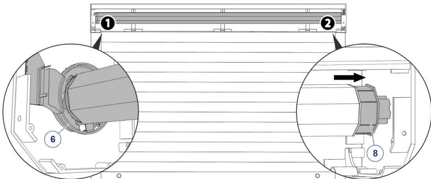
**16** Walzenkapsel an der Welle befestigen.
