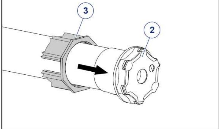
**5** Montaggio e fissaggio della ruota.
