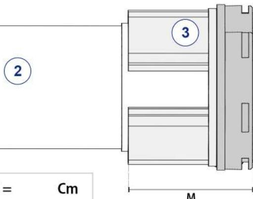
**B** Misurare la sporgenza del terminale del tubo.
