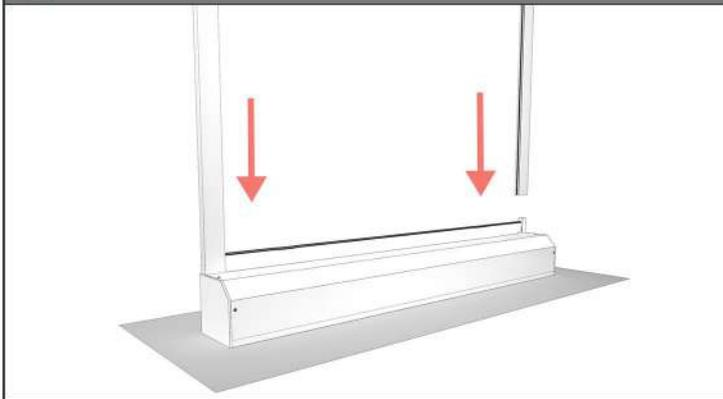
**3** Posicione la persiana enrollable contra el muro con el fin de verificar los topes altos y bajos del tablero.
