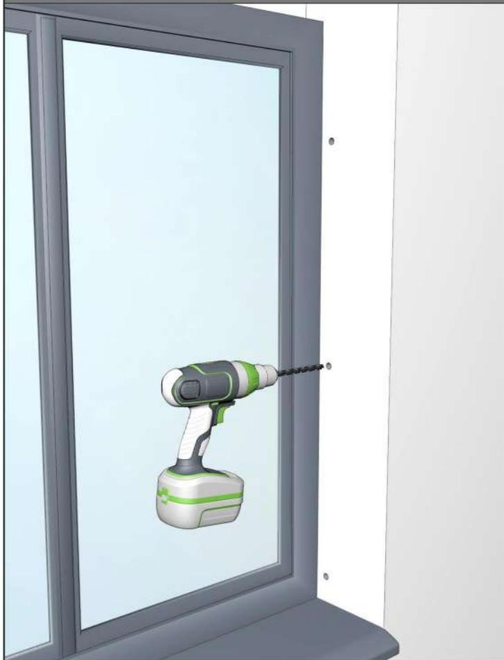
**10** Pase la maniobra de la persiana a través del marco (o la pared para la instalación de tipo applique) y vuelva a colocar todo el conjunto de la persiana.
