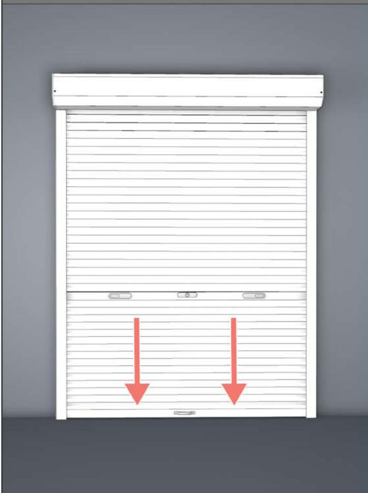
**5** Haga una marca en cada una de las guías en la parte superior de la lama intermedia (la lama con cerrojo).
