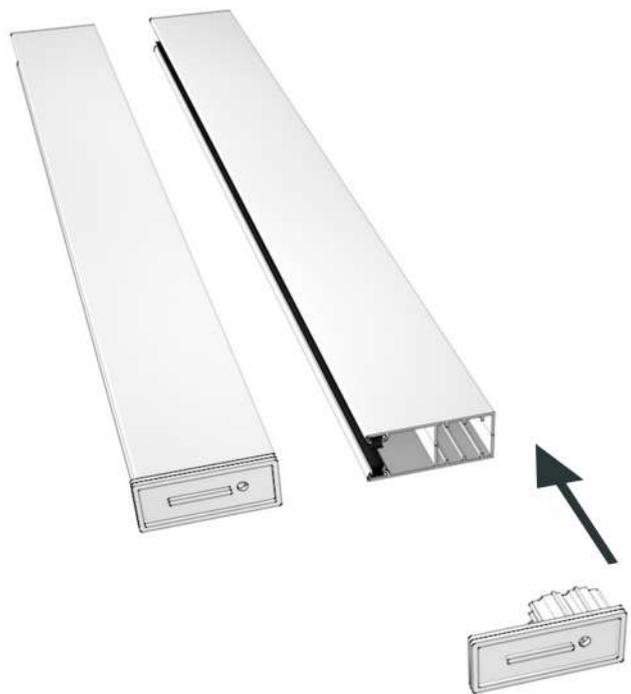
**8** Re-ensamblar las guías en el cajón.
