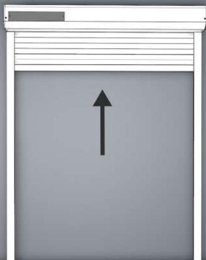
En el mando a distancia, mantenga pulsados los botones de subida y parada durante 5 segundos. (el motor se mueve hacia adelante y hacia atrás y emite un bip).
