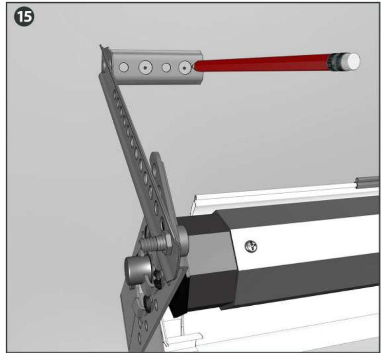
16 Die Halterung drehen, um zu bohren und anschließend die Schrauben zu befestigen (Schrauben nicht im Lieferumfang enthalten).
