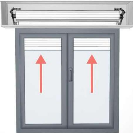
**D** Die Taste "Hoch" gedrückt halten. Um den oberen Endpunkt festzustellen, eine der Schrauben in Richtung **+** drehen. Wenn der Rollladenpanzer sich öffnet, ist dies die Schraube für den oberen Endpunkt. Wenn der Rollladenpanzer sich nicht öffnet, ist diese Schraube für den unteren Endpunkt zuständig. Den oberen Endpunkt anpassen, indem die Schraube in Richtung **+** gedreht wird.
