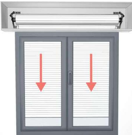
**F** Die Taste "Runter" gedrückt halten. Den unteren Endpunkt anpassen, indem die Schraube in Richtung **+** gedreht wird.
