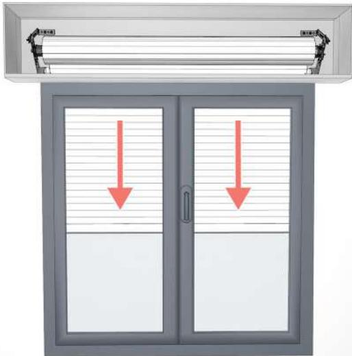
**B** Die beiden Einstellschrauben in Richtung **-** drehen.
