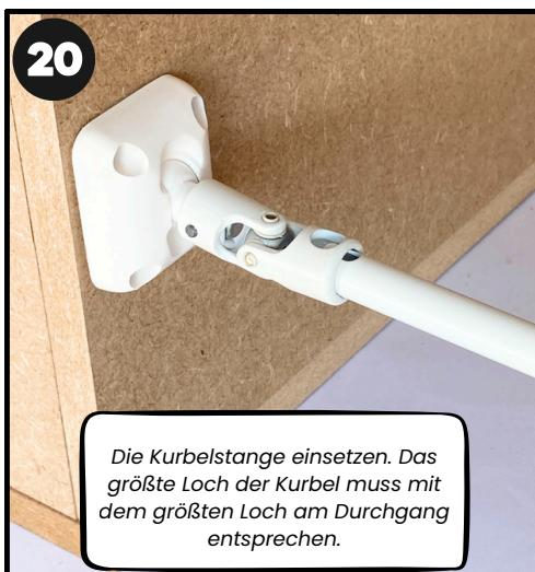
Die Kurbelstange einsetzen. Das größte Loch der Kurbel muss mit dem größten Loch am Durchgang entsprechen.
