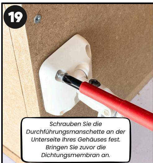
Schrauben Sie die Durchführungsmanschette an der Unterseite Ihres Gehäuses fest. Bringen Sie zuvor die Dichtungsmembran an.
